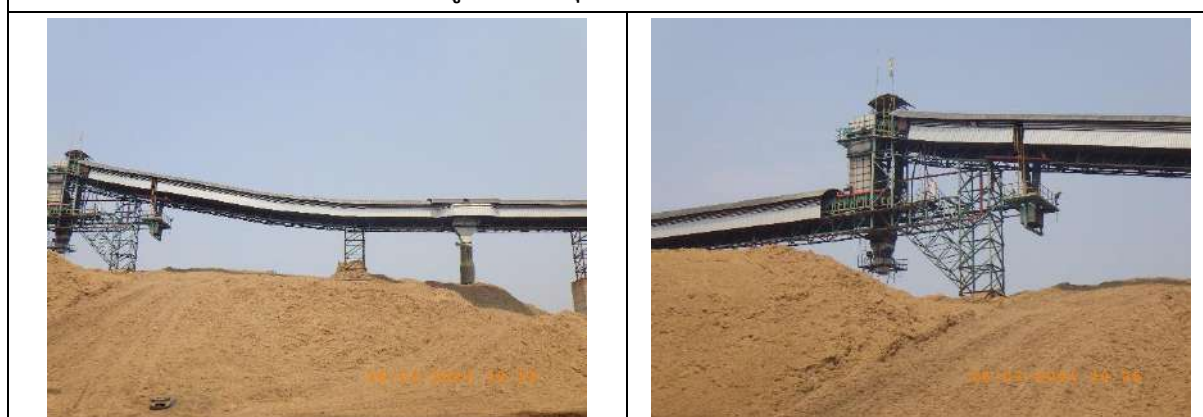
รูปที่ 2-9 ที่ครอบป้องกันฝุ่นฟุ้งกระจาย
